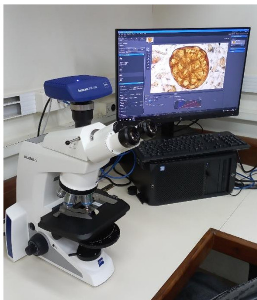
Figura 5 - Microscópio óptico (Zeiss) usado na contagem e identificação dos grãos de pólen preservados no guano.
