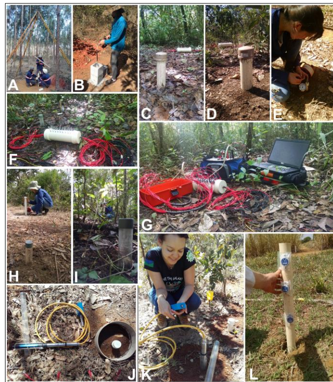
Fig. 7. Representação esquemática do experimento hidrológico subterrâneo em andamento na FAL-UnB. A-D) Poços de monitoramento do nível da água subterrânea. E) Manutenção dos tensiômetros. F-G) Linhas de ERI instaladas. H-K) Tubos de acesso padrão e PVC e sonda TDR utilizada no monitoramento da umidade do solo. L) Sensores de temperatura do solo. Fonte: de Almeida (2021).
