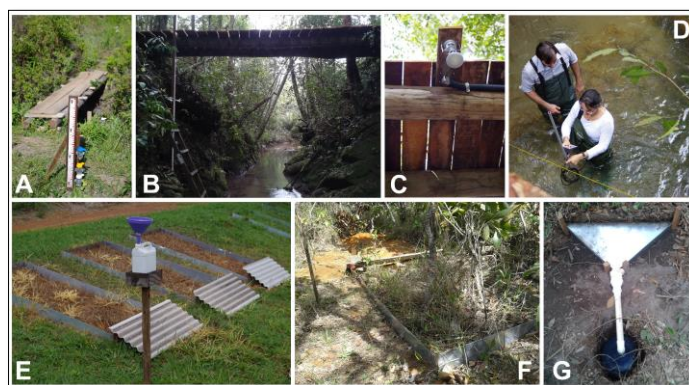
Fig. 4. Seção fluviométrica no exutório da bacia dos córregos A) Taquara (PCD2) e B) Capetinga (PCD1), com destaque, neste último caso, para c) o sensor de nível instalado na ponte do Córrego Capetinga e D) prática de medição de vazão para construção da curva-chave relacionando cota e vazão. Monitoramento do escoamento superficial em parcelas sob condição de cobertura do solo E) alterada (E2) F) preservada (P1), G) com calha de coleta. Fonte: Távora (2017).
