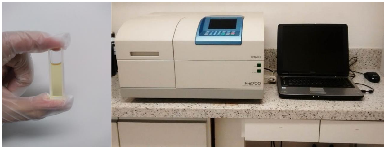
Figura 2.2 - Cubeta de quartzo eluente e espectrofotômetro de fluorescência HITACHI F-2700 acoplado ao computador
