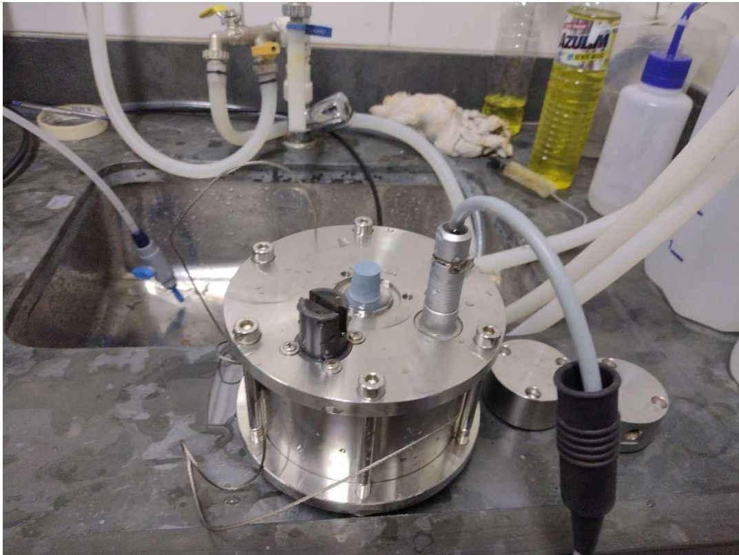
Fluorímetro GGUN-FL30 modelo 1650 (Schneeg 2002)
