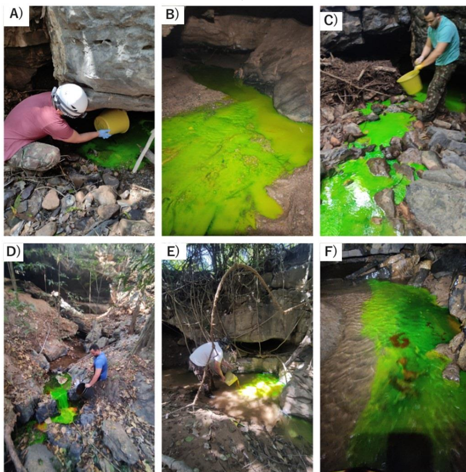
Figura 23 – Inserção do traçador corante fluoresceína sódica. Em A) e C) no sumidouro Saruê; B) na gruta da Tarimba (TF02); D) caverna Matadeiro; E) caverna Pasto de Vacas I; F) gruta das Dores II.
