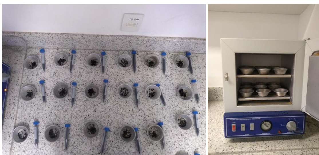
Figura 2.1 - Processo de secagem do carvão
