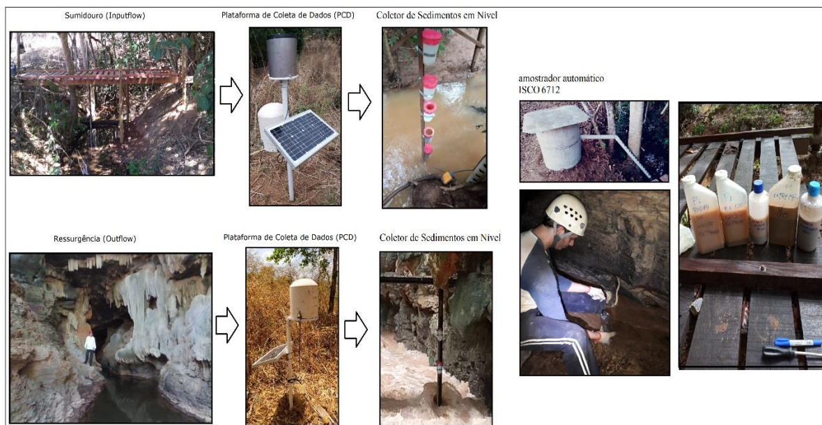
Figure 4. Fluxo de montagem dos equipamentos até a coleta de amostras de sedimentos. Fonte:Elaborado pelos autores.
