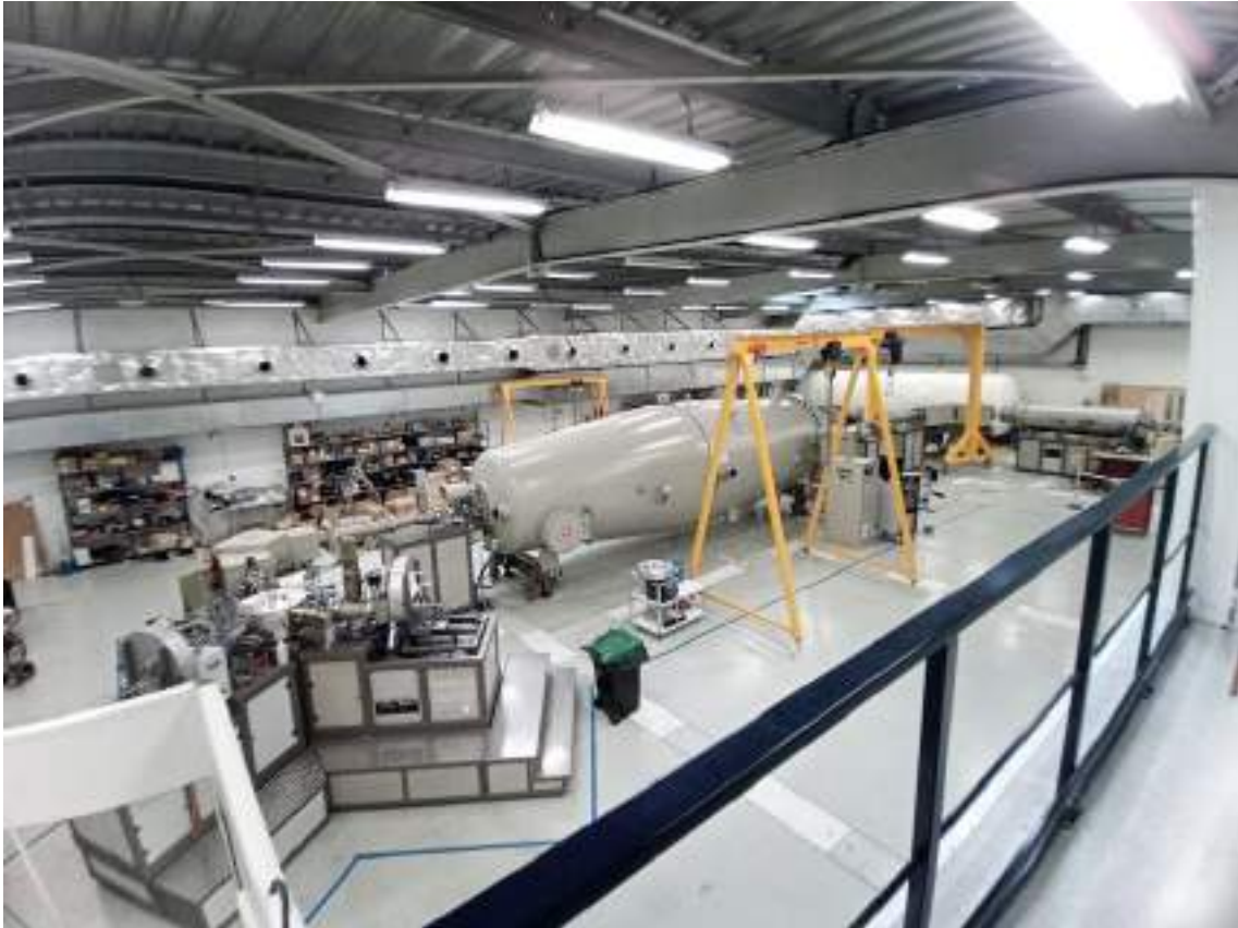
Figura 8. Composição do Acelarado ASTER, 5MV
