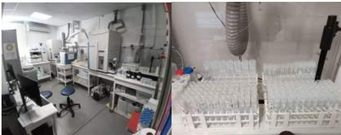
Figura 4 – esquerda:vista frontal do sistema ICP-MS AETE-ISSO; direita: sistema automatizado de coleta de amostras.
