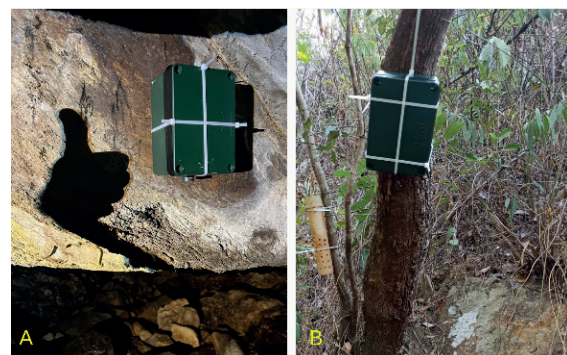
Figura 3: Ecopod: estojo adaptado para Audiomoth para maior autonomia e resistência no campo desenvolvido por Linilson Rodrigues Padovese e instalado no meio externo à Gruta do Palmito. A) Gruta do Palmito B) Meio externo (Autor: Ivan Campos).
