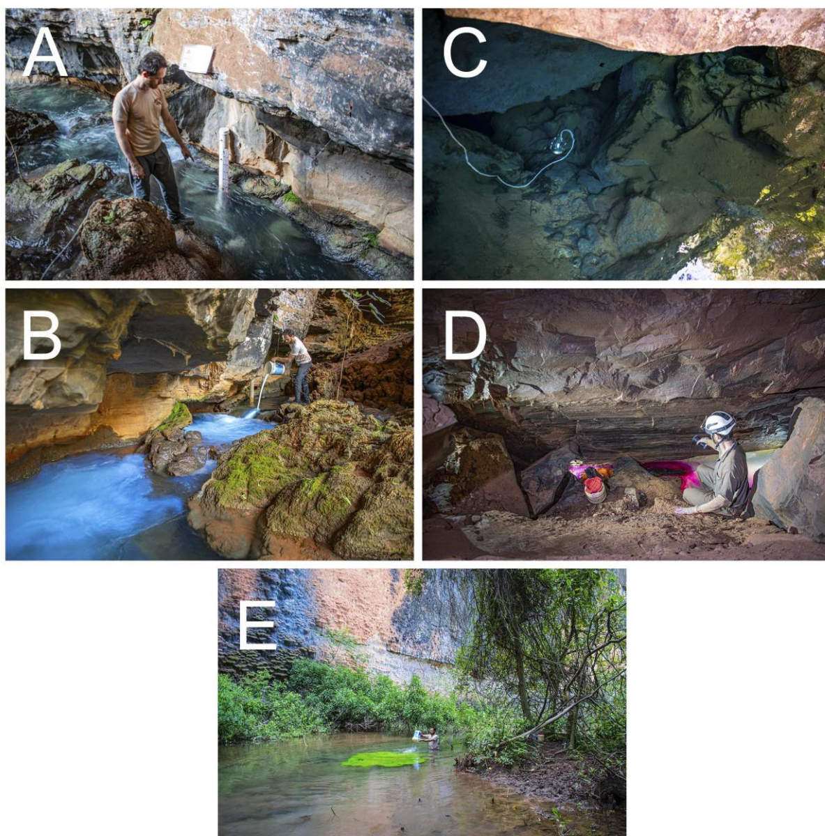
Figura 3: Testes de injeção com traçadores fluorescentes. A: Fluorímetro GGUN instalado no Sumidouro do João Baio; B: Injeção de tinopal no Sumidouro do João Baio; C: Fluorímetro GGUN instalado no Poço do Surubim; D: Injeção de Rodamina WT na caverna Garganta do Bacupari; E: Injeção de fluoresceína no sumidouro a jusante da Gruta do Catão.
