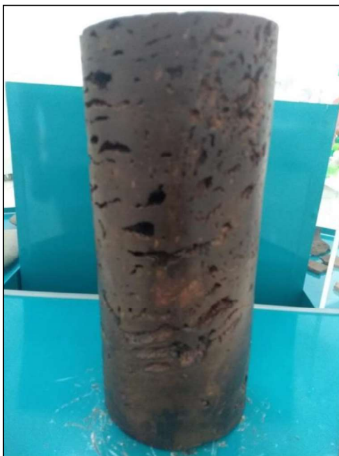
Figura 2: Testemunho de furo de sondagem de canga em Carajás evidenciando os canalículos e demais falhas presentes no subsolo interceptadas pelos furos de sondagem.
