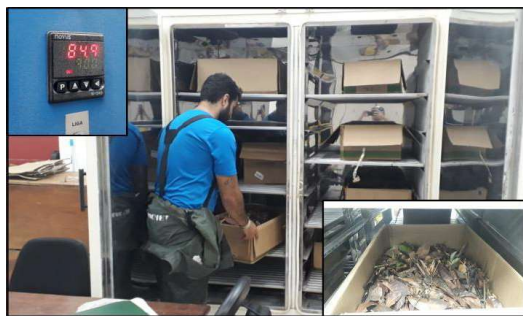
Figura 5: Esterilização do folheto coletado em campo a ser utilizado nas iscas. Este procedimento evita a contaminação prévias das amostras.
